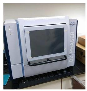
照片2 X 光粉末繞射儀 說明 貴儀新成員-X 光粉末繞射儀
