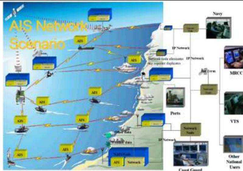
圖 11 立方衛星酬載 AIS 監測網示意圖
